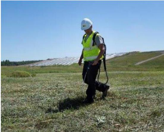
WM a partagé avec le Comité les résultats des suivis effectués sur le terrain pour vérifier que le réseau de captage des biogaz fonctionne bien, et qu'il n'y a pas d'émissions fugitives notables. Ces suivis sont réalisés sur l'ensemble du site, trois fois par année, à l'aide d'un appareil portatif indiquant les normes à respecter. En cas de dépassement de la valeur fixée par le ministère (500 ppmv - partie par million en volume), WM doit définir un plan d'action pour remédier à la
